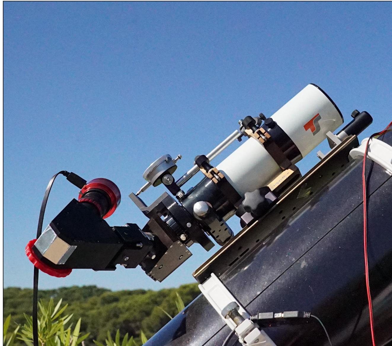
Utilisation d'un hélioscope pour l'atténuation du flux solaire
